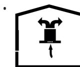
Воздух фильтруется через угольный фильтр (может быть опциональным в вашем устройстве и приобретается отдельно) и рециркулирует в помещении. Угольный фильтр применяется, когда в доме нельзя использовать дымоход.
